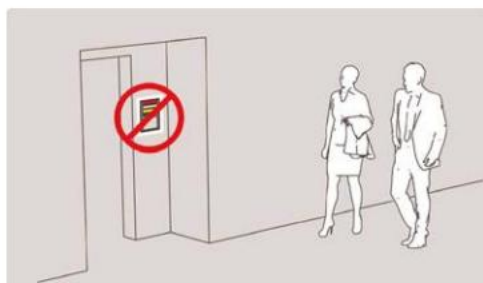
Negativan primjer: Nezakonito postavljanje jedne sobno signalno svjetlo u slabo vidljivoj niši
