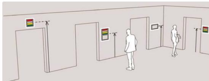
Postavljanje sobnih signalnih svjetala i znakova na vratima
