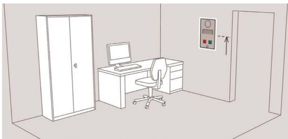
Postavljanje modula u dežurne prostorije
